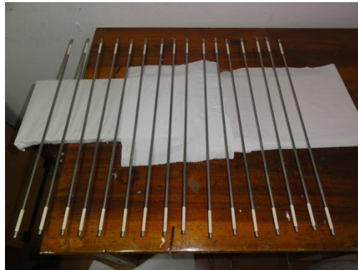
Figura 3.32. Contraelectrodos de acero inoxidable, para la medición de las barras mediante potenciostato/galvanostato de laboratorio.
