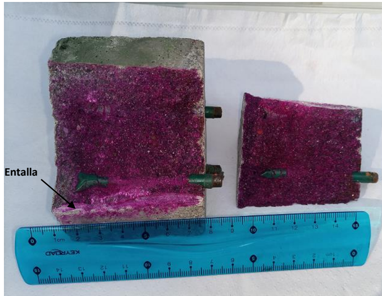
Figura 4.50. Test de la fenoltaleína realizado sobre una probeta inmersa en AD, con barras con la condición AR.
