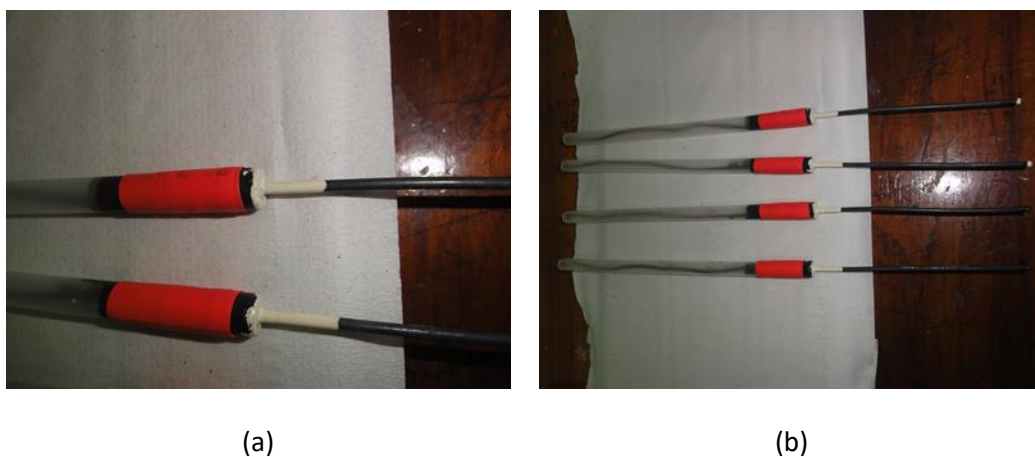
Figura 3.35. Fotos de los electrodos de referencia preparados para ser embebidos en las probetas.
