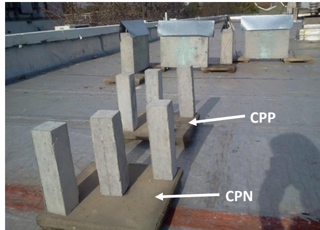
Figura 3.41. Probetas para medición de penetración de CO 2 expuestas al medio ambiente exterior, en terraza del Centro Atómico Constituyentes, CNEA.
