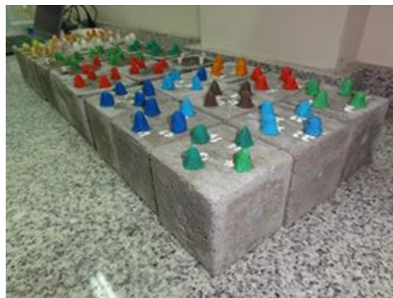
Figura 3.10. Probetas en reposo antes de ser expuestas a los diferentes medios corrosivos.
