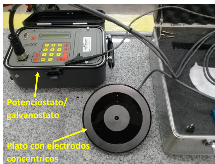
Figura 3.43. Instrumento comercial Gecor 6 para el monitoreo de la corrosión del refuerzo en estructuras civiles.
