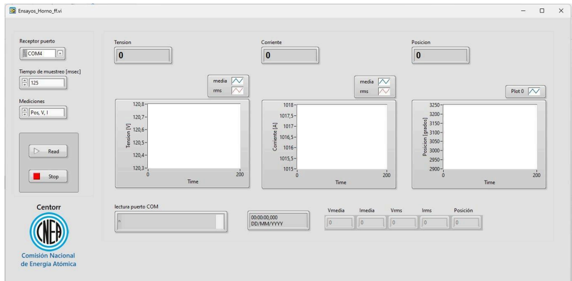
Figura 44 - Nueva Interfaz software LabView. Representación de Posición, Tensiones y Corrientes medias/eficaces en tiempo real.
