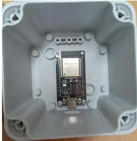
Figura 39 – Nuevo Módulo receptor wifi y adaptador USB.
