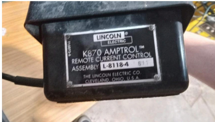
Figura 10 - El pedal “hombre muerto” es un sistema de seguridad para asegurar que el operador está en condiciones de manipular el desplazador.
