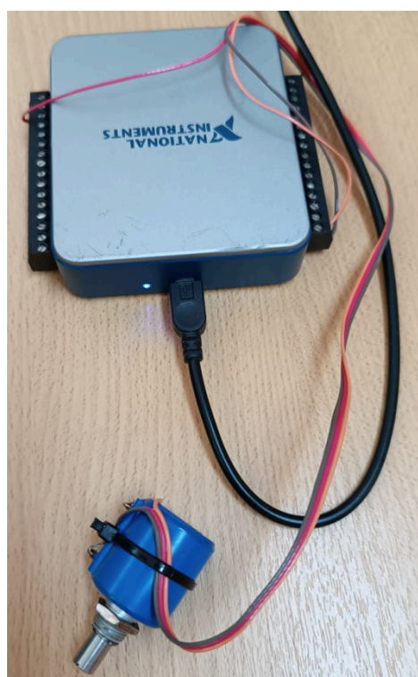
Figura 29 - Potenciómetro - Placa National Instruments USB
