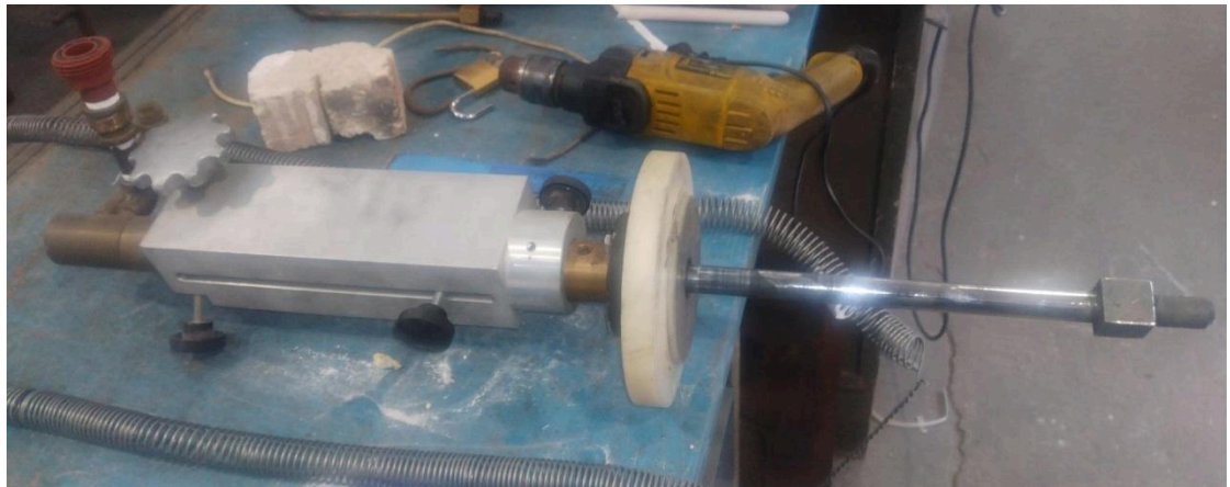
Figura 4 - Desplazador conectado al electrodo y solidario con potenciómetro
