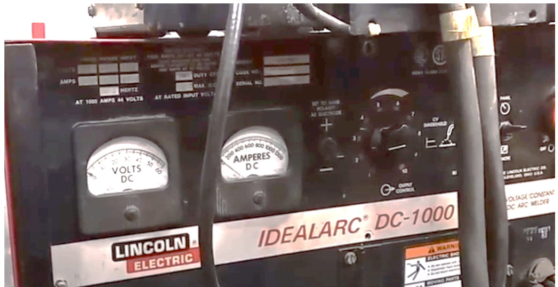
Figura 18 – Frente de la fuente Lincoln donde se aprecian los indicadores de tensión y corriente medias y la perilla de ajuste de nivel.
