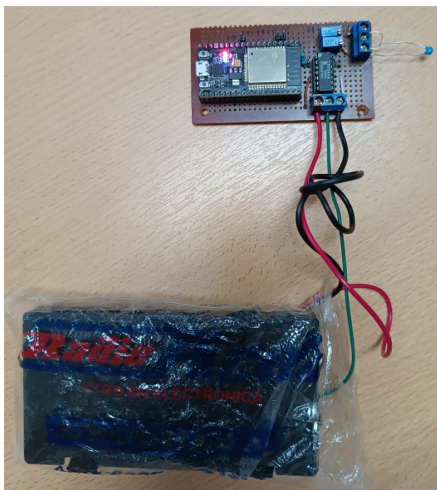
Figura 28 - Placa ESP- 32 - Wi Fi adquisidora y batería.
