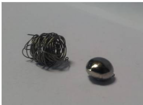
Figura 4.11: Preparado de un botón de Ti a partir de alambre en el cañón de electrones del equipo PVD.
