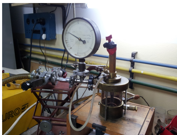
Figura 5.4: Horno de fundición por arco.
