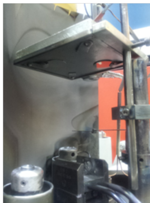
Figura 4.12: Colocación de sustratos de cobre sobre placa calefactora (izquierda) e interior de cámara PVD con muestras evaporadas (derecha).
