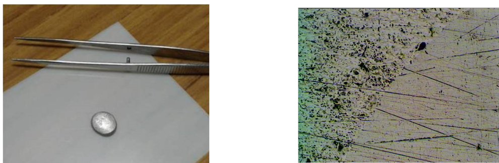
Figura 5.6: Primera fundición de la muestra «A» de una aleación multicomponente de MoTaVWZr (izquierda). Imagen del microscopio óptico tomada durante la inspección de una sección transversal de la muestra (derecha).
