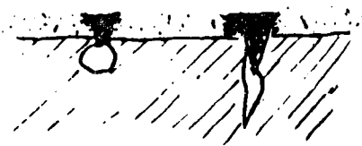
e) Extracción del penetrante por el revelador
