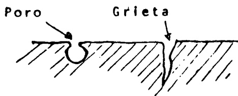
a) Superficie limpia con fallas
