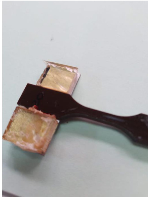
Figura 5: modificación probetas con cuñas paralelas a la cabeza de probeta
