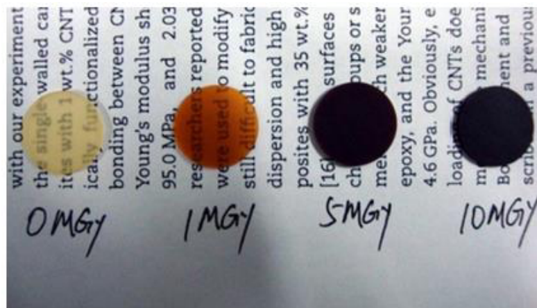
Figura 52: Cambio de coloración de las probetas ensayadas con DGEBA después de ser irradiadas a 0, 1, 5 y 10 MGy. Tomado de (Wu, Li, Huang, Huang, & Li, 2013)
