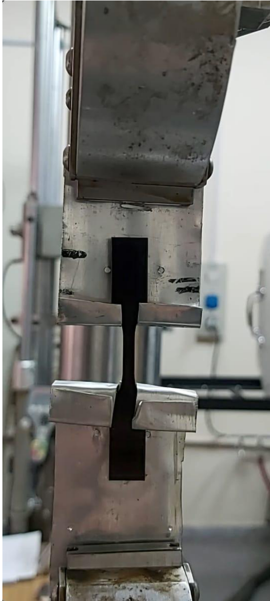
Figura 7: Modificación de sistema de agarre de probetas
