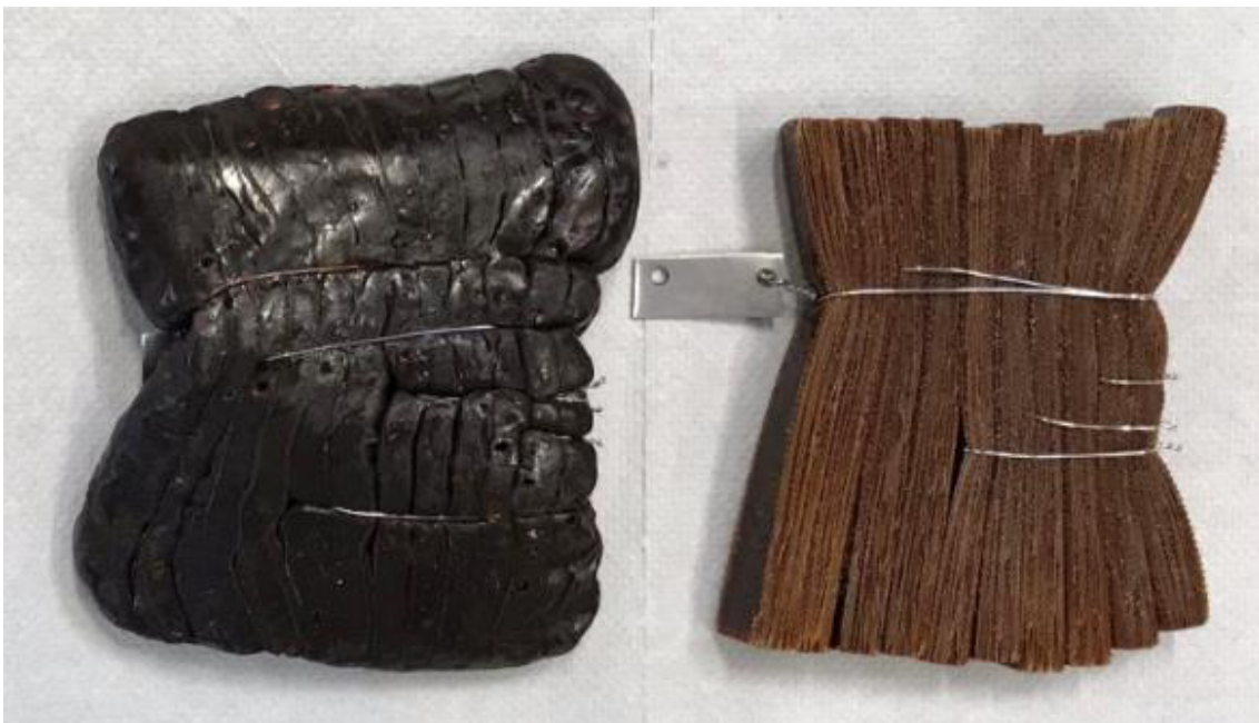
Figura 48: Probetas de MY 750 después de ser irradiadas a 20 MGy. Tomado de (Marraco Borderas, Fagundes de Sousa, & Del Valle Grande, 2020)
