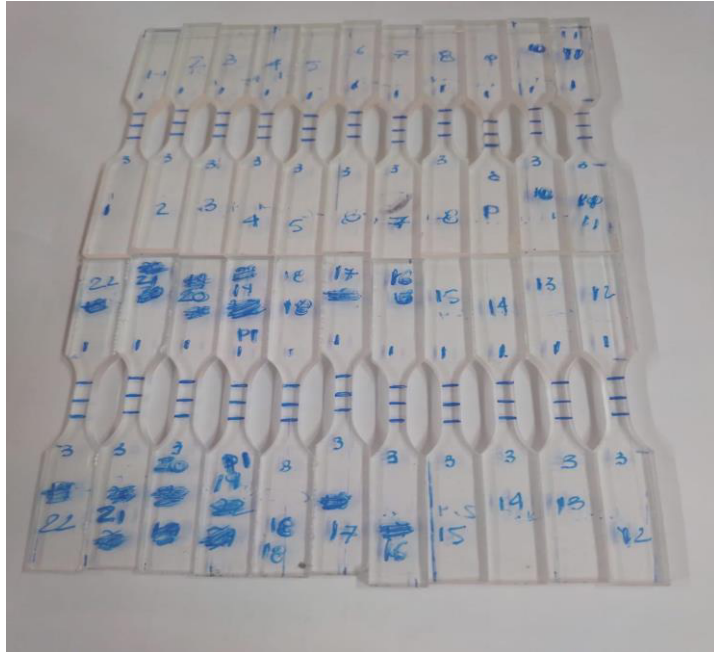
Figura 62: Probetas organizadas como la segunda plancha, se observa mayor espesor aumenta en dirección de la probeta 11, mostrando que en este lugar estaba más desbalanceado respecto los otros lados
