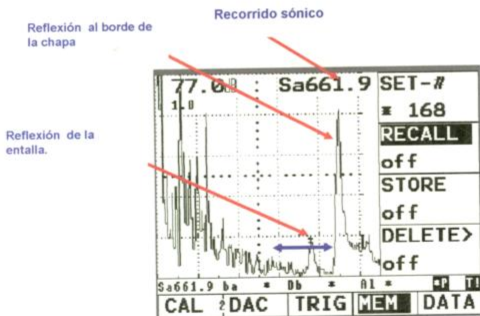
Figura 5.11. Reflexión del modo S_0 , en la entalla en chapa de 1mm. Aluminio
