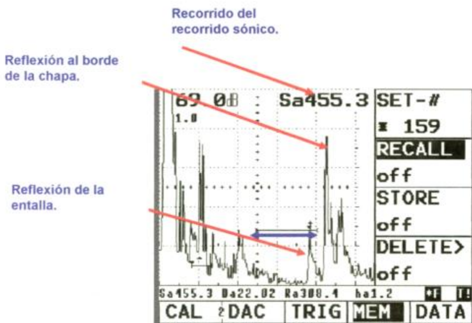
Figura 5.14. Reflexión del modo A_0 de la entalla en chapa de 1mm. Acero.
