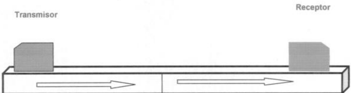
Figura 1.2 Esquema del principio de medida de Transmisión y recepción y Propagación de onda Lamb en chapa (aluminio o acero).
