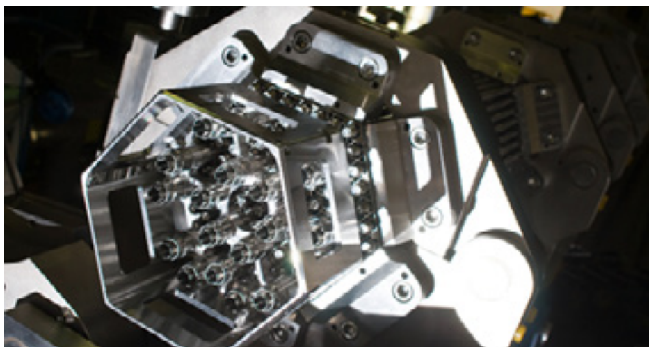
Figura 7: Elemento combustible del reactor CAREM, CNEA.
