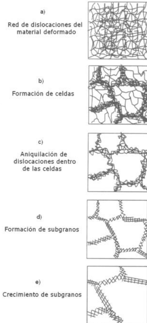
Figura 1.2. Varias etapas en la recuperación de un material deformado plásticamente.
