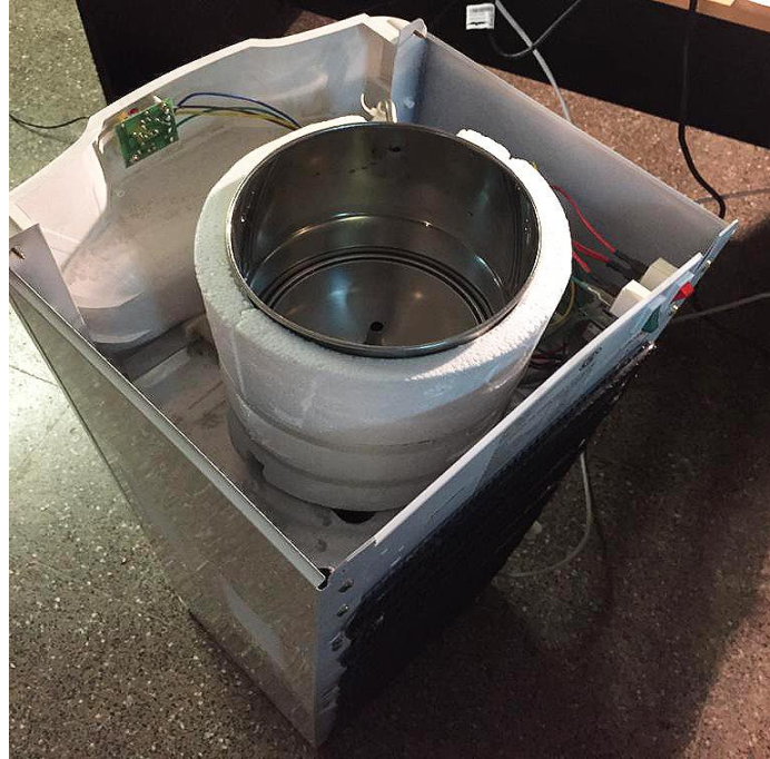
Figura 3 - Aquí se aprecia el aislamiento del tanque de agua fría.
