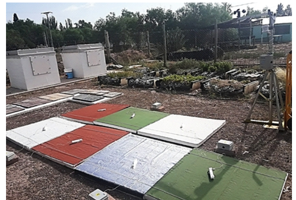
Ensayo opto-térmico de muestras en el taller del INAHE-CONICET.
