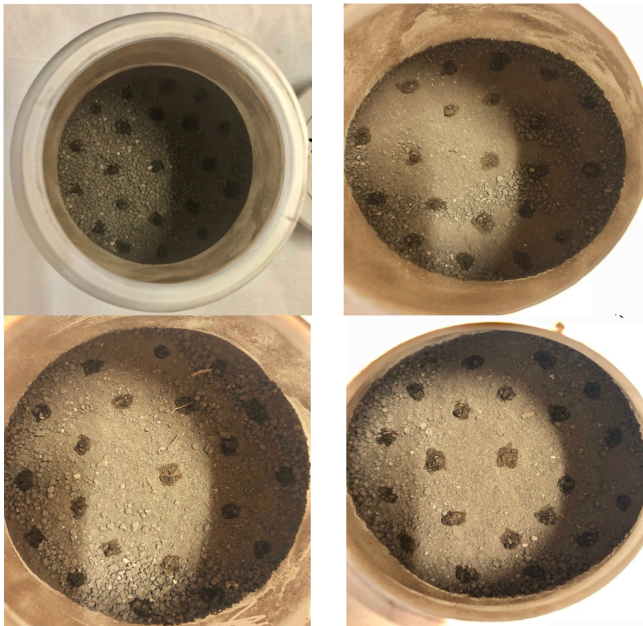
Figura 2.4. Las cuatro capas de siembra de la solución radiactiva en el patrón de tierra preparado en capas. De izquierda a derecha, de abajo hacia arriba: capa 1, capa 2, capa 3 y capa 4.
