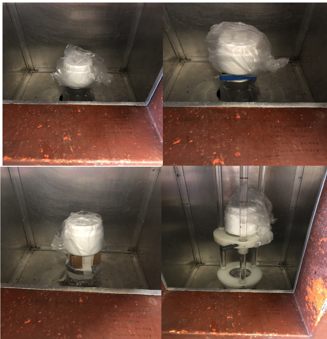
Figura 2.7. Arriba-izquierda: mediciones en contacto; arriba-derecha: mediciones a 2 cm del detector; abajo-izquierda: mediciones a 4 cm del detector; abajo-derecha: mediciones a 17 cm del detector.
