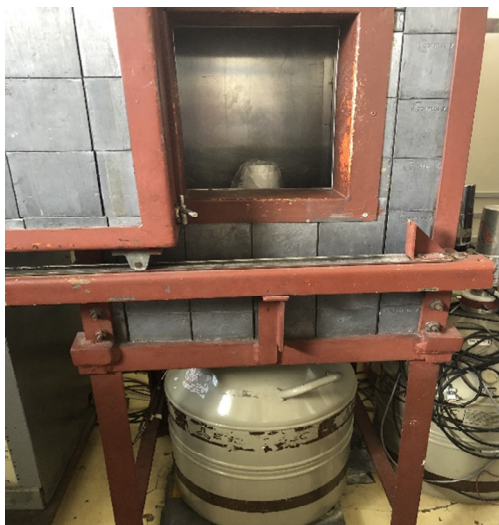
Figura 2.6. Detector de HPGe utilizado para las mediciones, perteneciente al Laboratorio Metrología de Radioisótopos, Centro Atómico Ezeiza.
