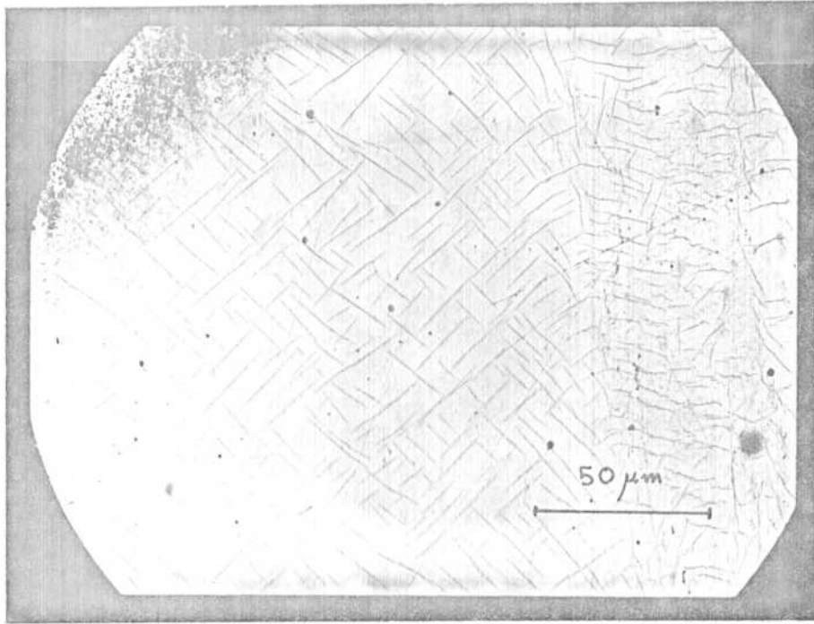
Figura C3. - Nitruros en Fe-Si. Chapa laminada en frío hasta 0,70 mm, luego nitrurada a 550°C, 40 horas.
