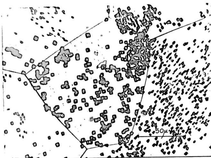
Figura C8. - Chapa totalmente procesada. Figuras de corrosión.
