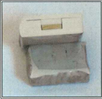
Fig 4.20: Encapsulado E1-M1. Separación excesiva entre base y tapa.
