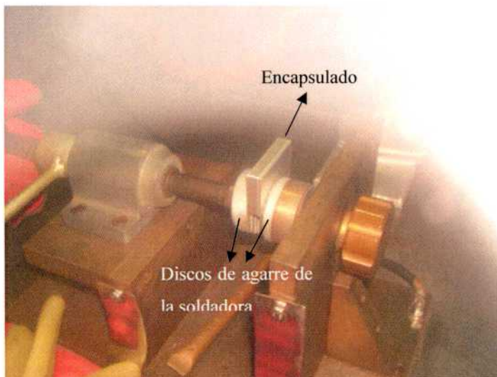
Fig 4.23: Posicionamiento del encapsulado previo a la soldadura.
