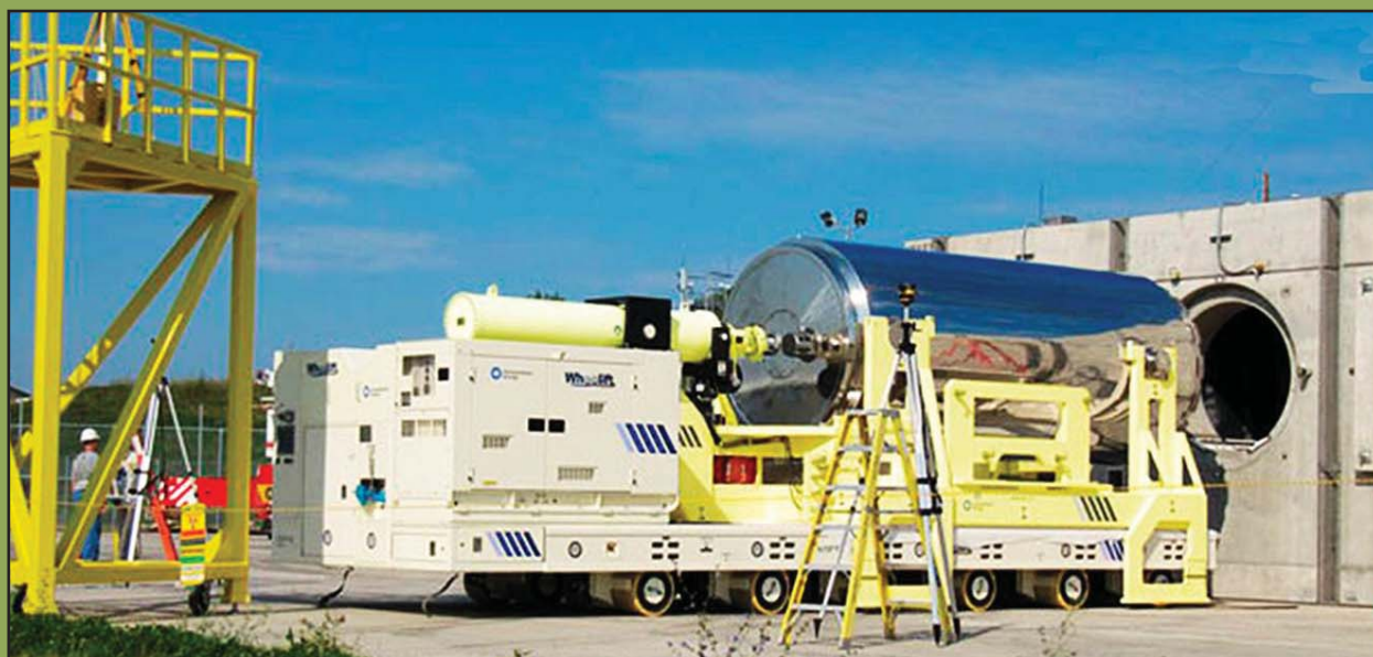
Figura 5: NUHOMS | Casco para transporte y almacenamiento en seco de combustibles gastados.
