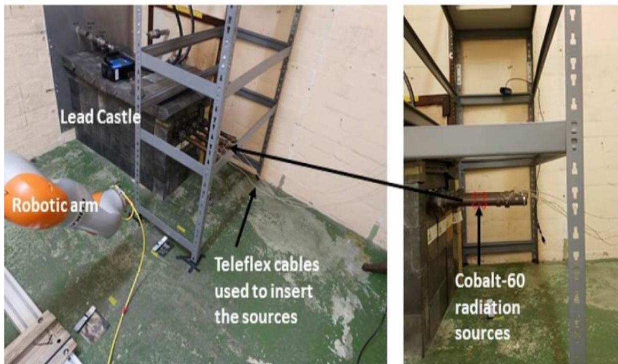
Figura 5.17: Entorno de prueba en la celda con una fuente de alta actividad de ^{60}\text{Co} del robot KUKA iiwa LBR, Extraído del artículo científico [22]
