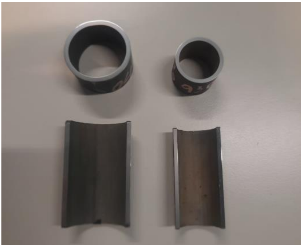
Figura 20. Muestras de tubos antes y después de la segunda pasada de trefilado, respectivamente.
