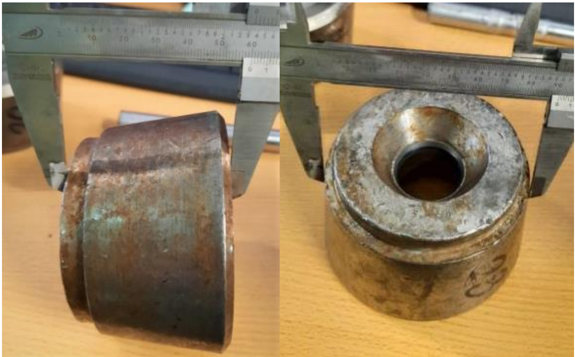
Figura 16. Fotos de una de las matrices utilizada en el proceso (Diámetro en la zona calibrada \varnothing :28,1mm)
