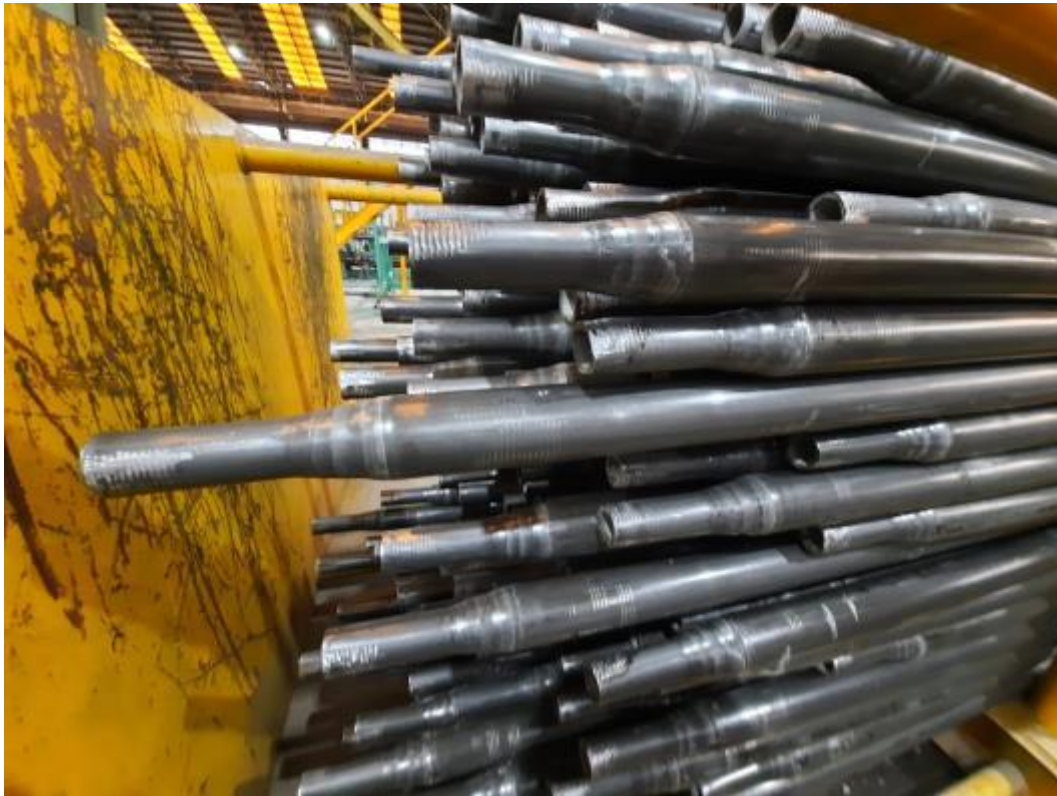
Figura 7. Tubos con un extremo de diámetro reducido luego de la operación de apunteado..
