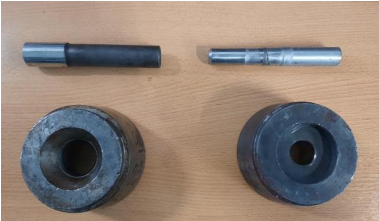
Figura 17. Fotos de matrices y mandriles utilizados en el proceso.
