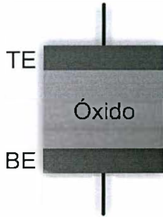
Figura 1.1: Celda típica metal - óxido - metal donde se observa la conmutación resistiva. El óxido se deposita entre dos electrodos metálicos, electrodo superior TE e inferior BE.
