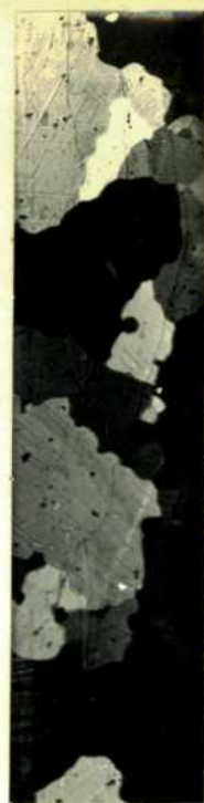
N° 17 - x 20. Cristaux de recristallisation après écouissage ( à comparer à la fig. 1 )
