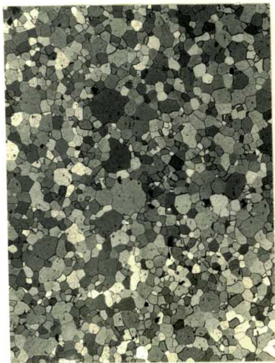
N° 18 - x 75. Grosseur du grain obtenu après 5 H à 630°C.
