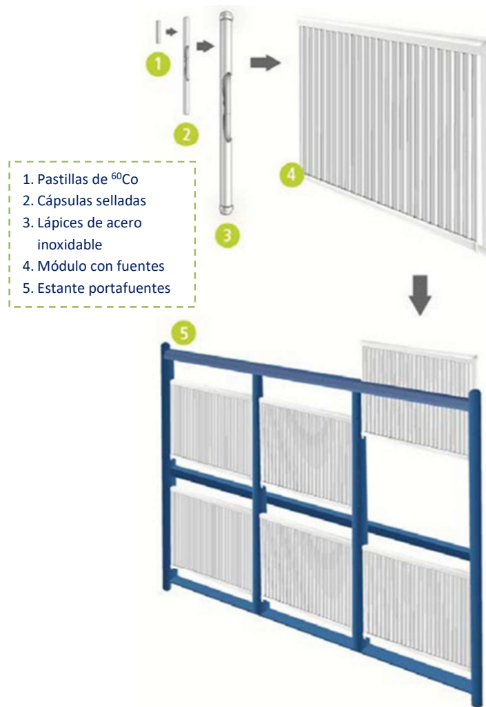
Figura 3. Esquema del arreglo de lámpices de ^{60}\text{Co} en módulos ubicados en un estante portafuentes [84]
