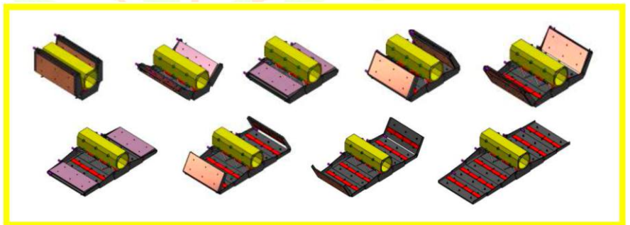
Secuencia de despliegue de la antena.
