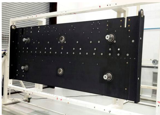
Uno de los siete paneles que componen la estructura de la antena.
