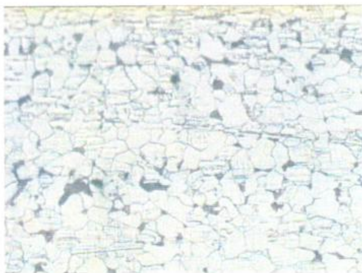
Fig. 5 Metalografía acero SAE 1010 sección longitudinal 100x
