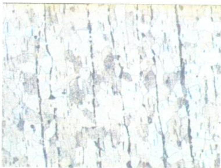
Fig. 10 Metalografía acero SAE 12L14 sección longitudinal 100x.
