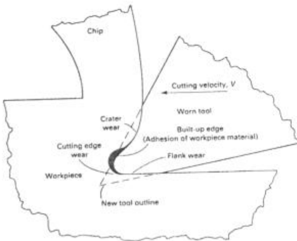
Fig. 2.3 Superficies típicas de desgaste
