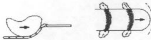
Figura III.2.5. Representación esquemática del modo de fractura en la prueba de rayado para el Ti
