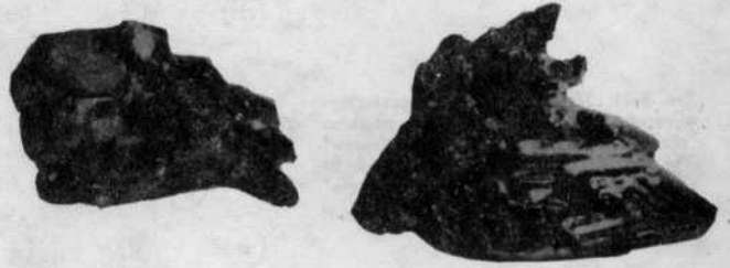
FIG. 23. — Cristaux de magnésium obtenus par sublimation et montrant des faces planes bien développées (grandeur naturelle).
