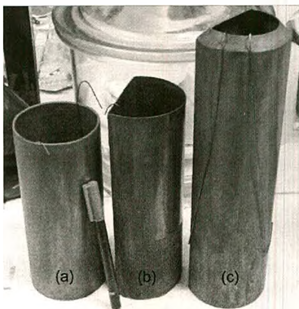
Figura 3.4: Liners utilizados y ganchos de alambre de Zry-4. (a) liner de Titanio, (b) liner semicilíndrico de acero inoxidable 316L, (c) liner semicilíndrico de acero inoxidable 316L con solapa.
