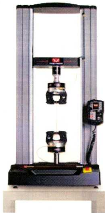
Figura 2.2. Máquina de ensayos universales INSTRON 5569.
