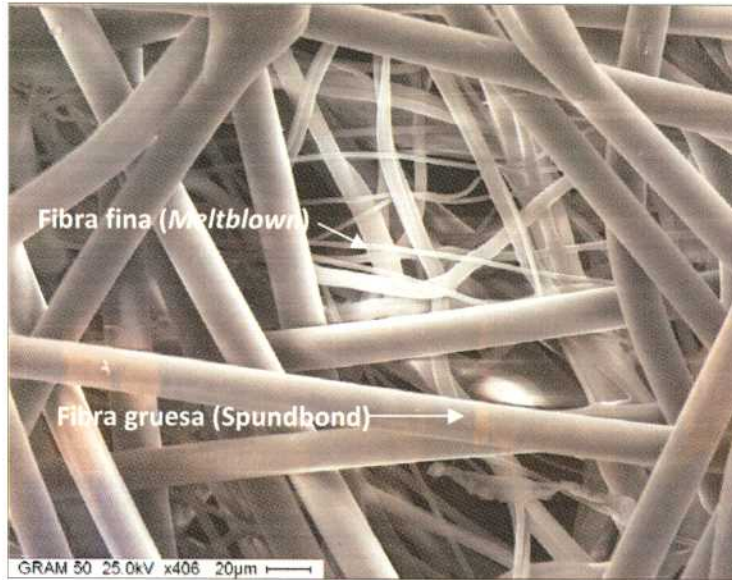
Figura 2.14. Micrografía SEM de las fibras de PPnt
