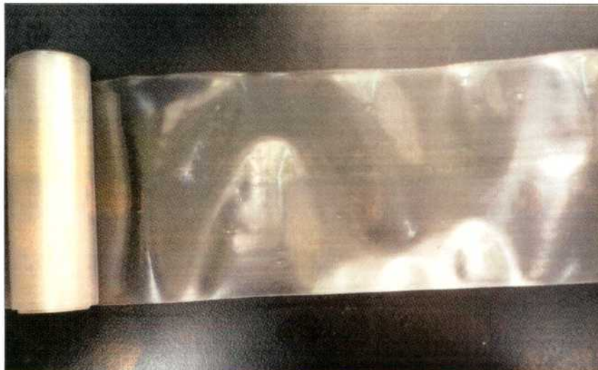
Figura 3.2. Lámina obtenida por extrusión plana de PPr.
