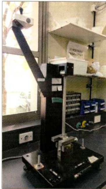
Figura 2.4. Péndulo de impacto Izod CSI
