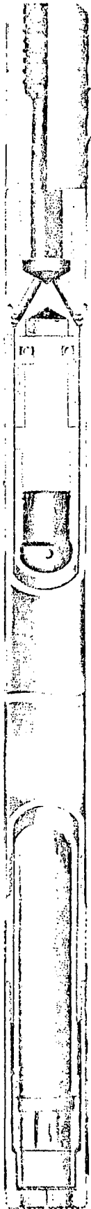
FIG. 5 - "SACATESTIGO" doble tubo gira- torio "WM".
