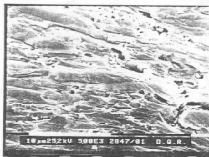
Foto 52. Presencia de cavidades típicas de la fractura dúctil. Probetas traccionadas con carga de hidrógeno. 5000X.
