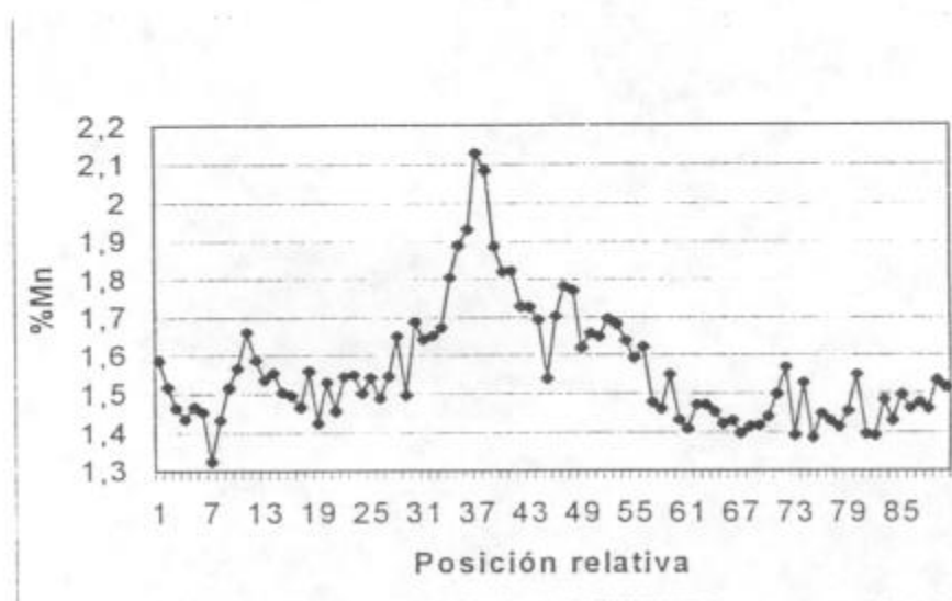
Figura 17. Segregación de Mn en la zona central del espesor de la muestra. Zona G del caño.
