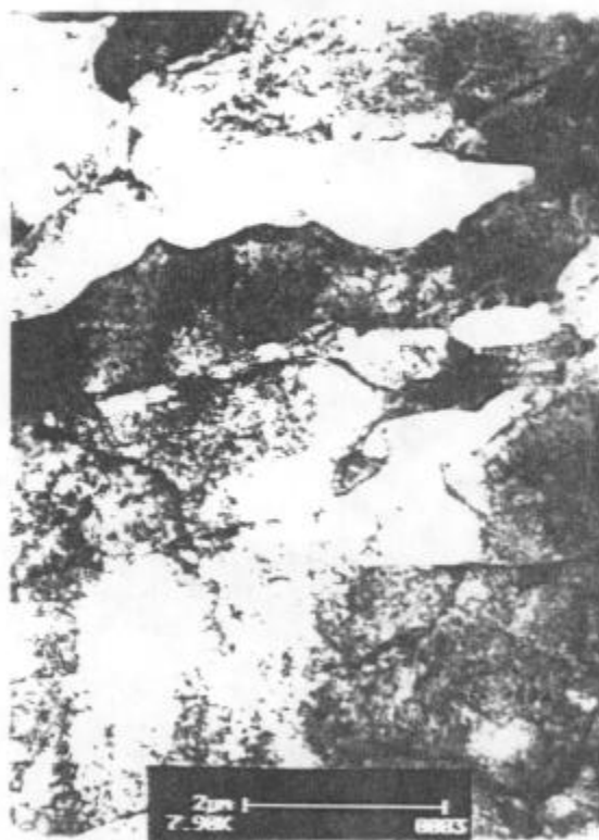
Foto 5. Metal base. Zona G del caño. Granos ferríticos muy chicos. 10000X.
