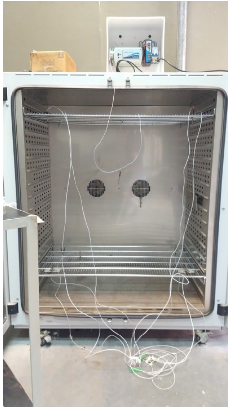
Figura 33. Termocuplas en el horno para la verificación.
