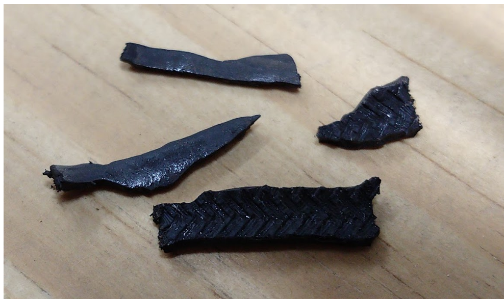
Figura 29. Liquido oleoso en trozos de PVC desprendidos del cable de la calificación anterior.
