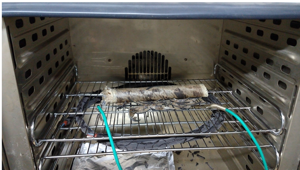
Figura 28. Muestras del cable válvula FIAT y cable de una calificación antigua dos semanas a 170 °C.
