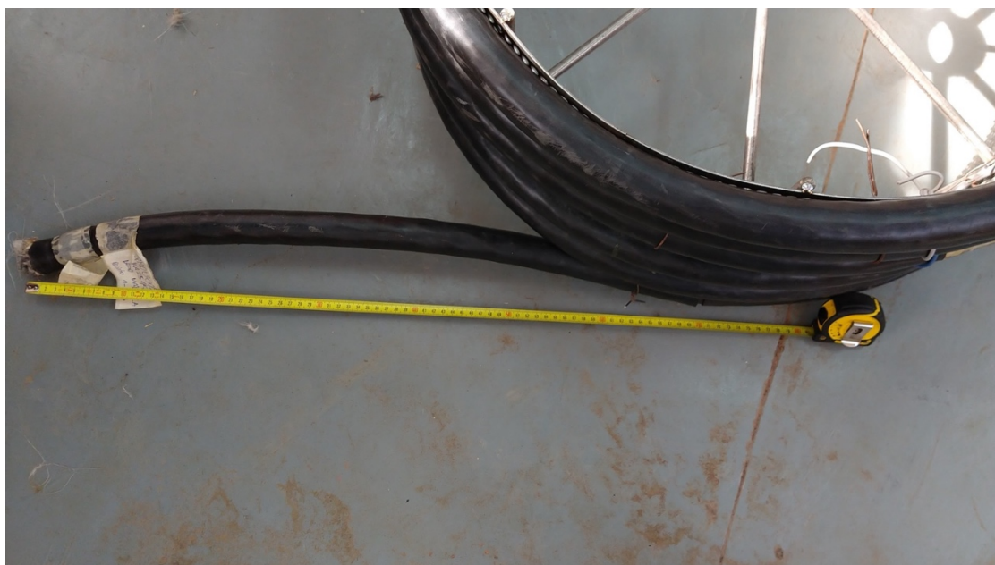
Figura 35. Distancia del extremo del cable a la fisura.
