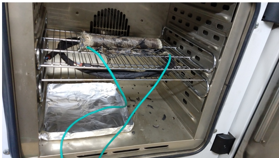
Figura 27. Muestras del cable válvula FIAT y cable de una calificación antigua una semana a 170 °C.
