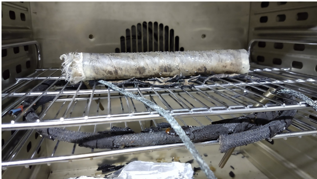
Figura 30. Muestras de cable luego de una semana con el horno apagado.
