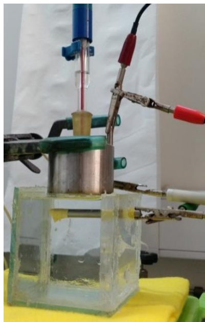
Figura 20. Celda electroquímica de vidrio utilizada para determinar el factor de celda ( K_F ) mediante Espectroscopía de Impedancia Electroquímica.
