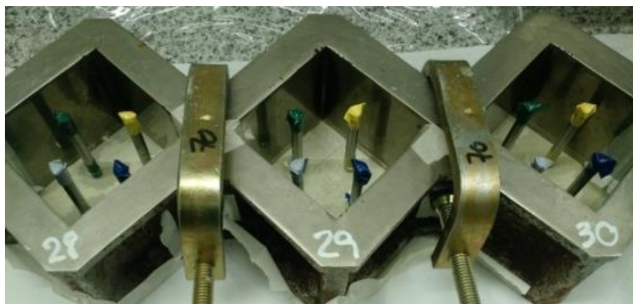
Figura 12. Molde con el acrílico y las barras listos para la colada de mortero.
