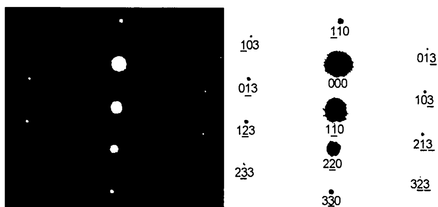
Figura 53. Diagrama de difracción electrónica tomado en la muestra 1 tratada a 900°C (168 h) en zona libre de precipitados, con eje de zona [331].
