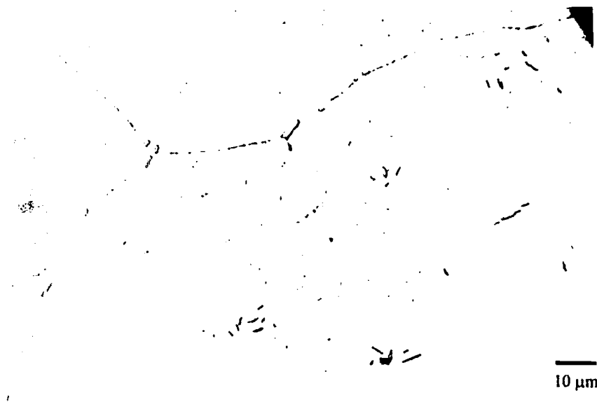
Figura 48. Micrografía óptica de la muestra 1 tratada térmicamente a 900°C (168 h).
