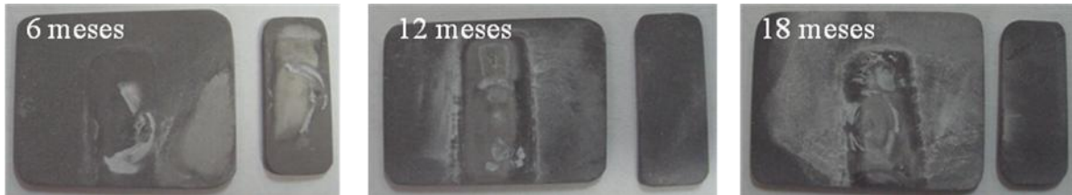
Fig. 3.16 Placas base y placa superior de las rendijas sumergidas en solución de NaCl 0,001 M . Se indican los tiempos de inmersión.
