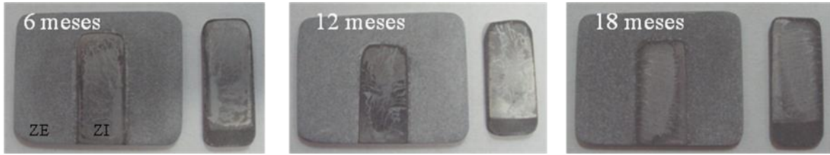
Fig.3.15 Estado de las placas base y placa superior de las rendijas sumergidas en agua de alta pureza . Se indica en cada caso el tiempo de inmersión.
