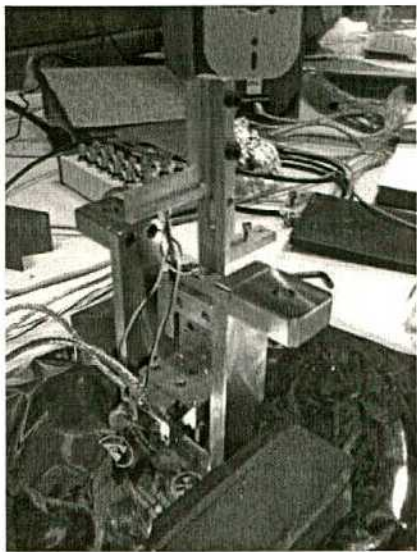
Figura 4.24: Nanoposicionador con mástil y adaptador para la plataforma que sujeta las muestras.
