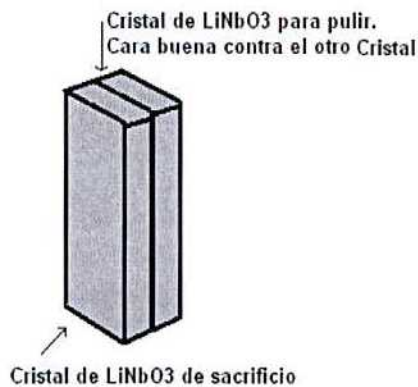
Figura 5.8: Disposición del cristal de Niobato de Litio para el pulido.
