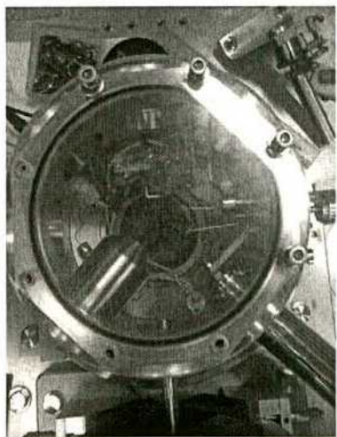
Figura 4.25: Vista superior de la cámara de irradiación a través de la tapa superior de acrílico.
