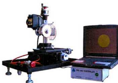
Figura 5.2: Sierra MTI Corporation con el controlador CNC.
