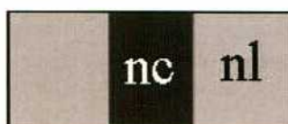
Figura 3.36: Índice de refracción en la zona central ( n_c=2,11699 ) y en la zona lateral ( n_l=2,102 ).
