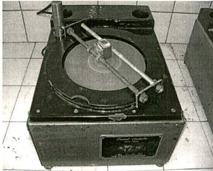
Figura 5.6: Pulidora con sistema de sujeción de la muestra.
