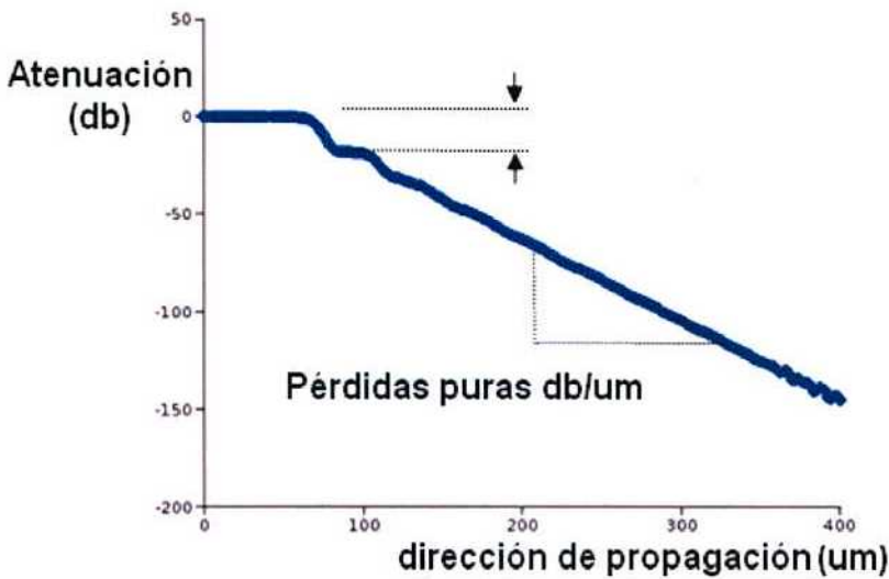
Figura 3.39. Pérdidas para un radio de 100 \mu\text{m} para una guía de ondas curva. El escalón inicial es debido a las pérdidas por el ingreso a la guía curva. La pendiente posterior es debido a las pérdidas intrínsecas a la curva.
