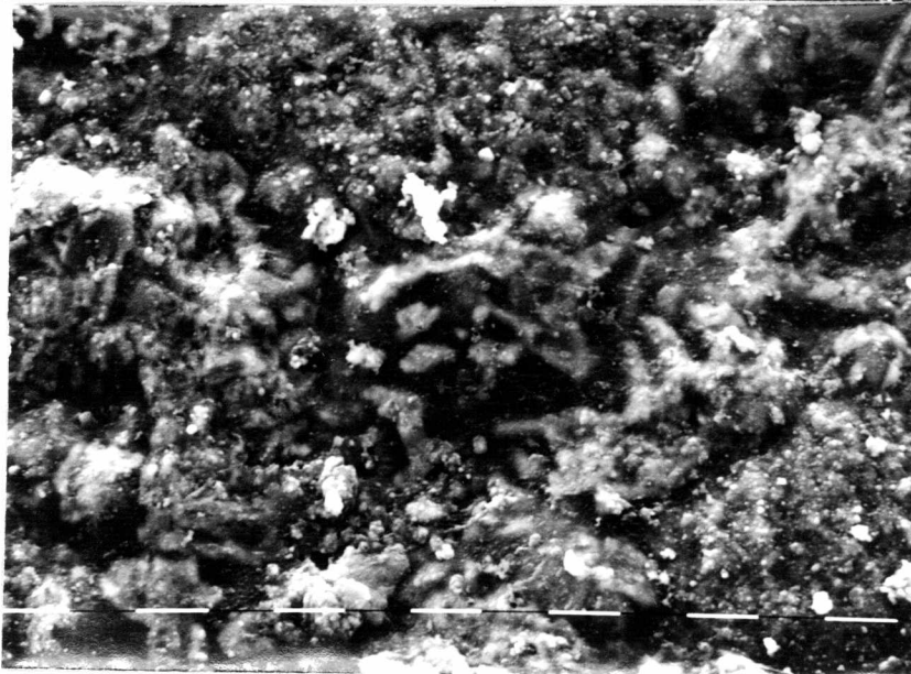
FIGURA 2. Probetas pasivadas en \text{H}_2\text{S}/\text{NaOH } 10^{-3} (pHeq= 3,81)
