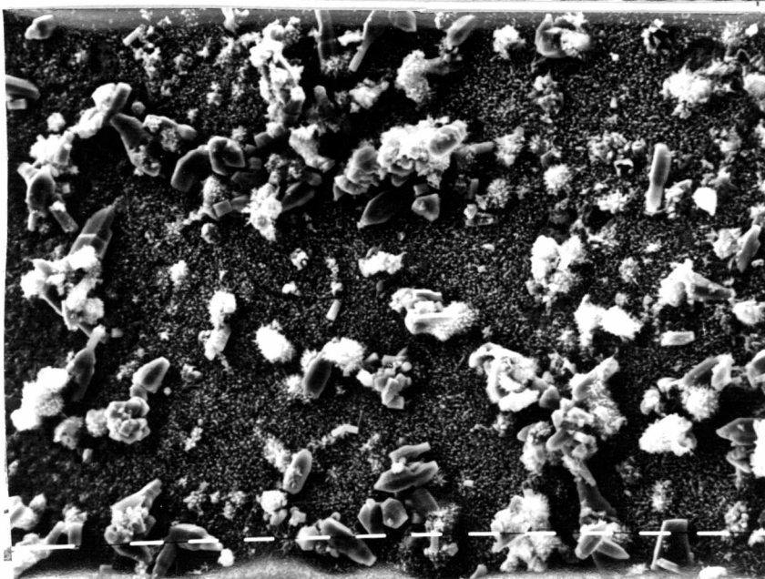
FIGURA 3 . Aspectos de capas de sulfuros de hierro. Probetas pasivadas en \text{H}_2\text{S}/\text{NaOH } 10^{-3}\text{M} ( \text{pHeq} = 3,81 )
