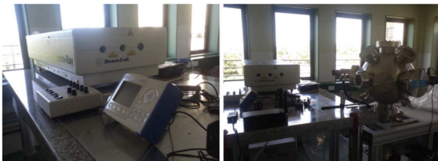
Figura 3.15: Fotografía del equipo MBM PLD, ubicado en el Centro Atómico Constituyentes.
