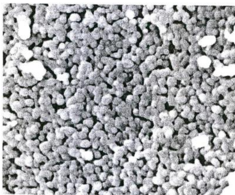
Fig. 4.4.4 Micrografía 10.000 X de un recubrimiento de APA 0.5 sinterizado a 1400°C.
