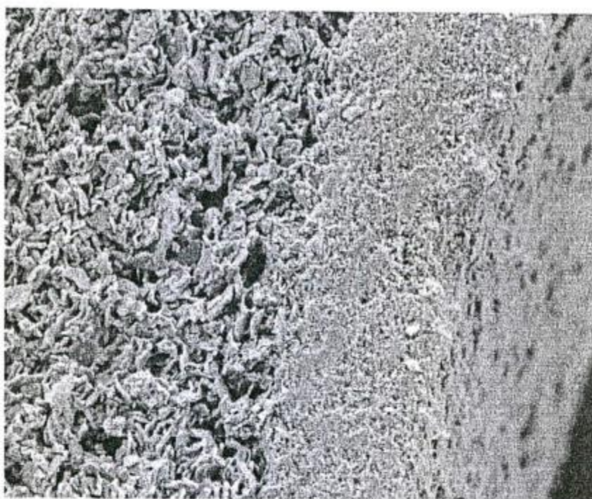
Figura 4.4.3 Capa depositada sobre la cara interna del tubo macroporoso
