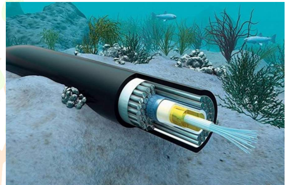
Fig. 1 - Los cables submarinos se apoyan en el lecho marino y poseen un diámetro entre 17 y 77 mm, según la profundidad a la que se encuentren. Normalmente este cable lleva ocho pares de fibras ópticas y está protegido por alambres de acero trenzado, aluminio y varias capas de polímeros. También lleva la alimentación eléctrica necesaria para que funcionen los láseres de bombeo de los AOs. 6
