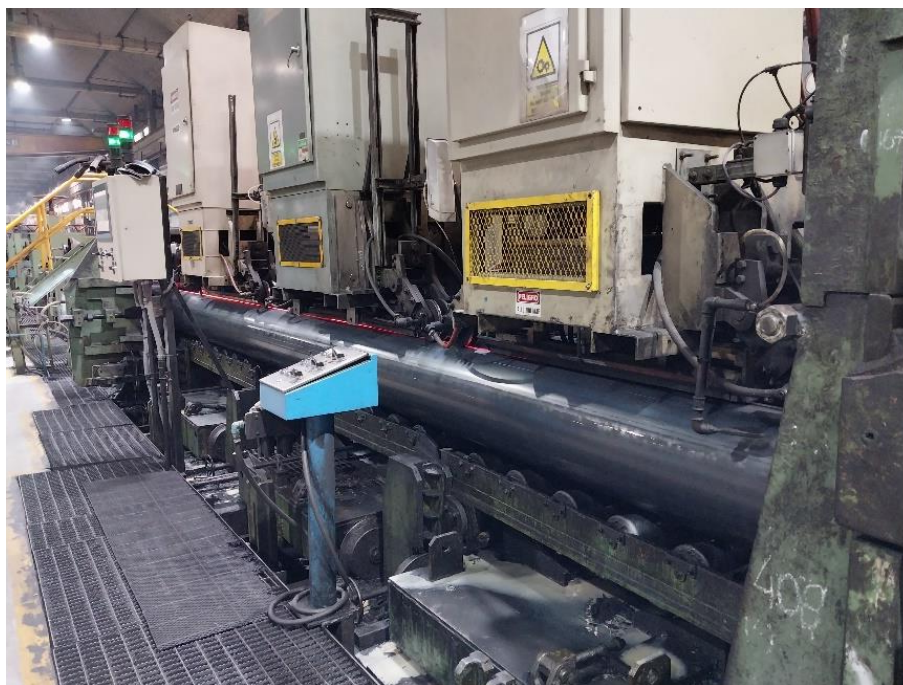
Figura 3. Vista del tratamiento térmico de costura en una línea de fabricación de tubos con tres inductores lineales.
