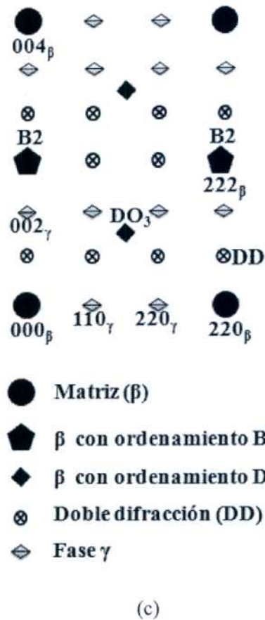
Fig. 3.12: (a) Patrón de difracción del eje de zona de [1\ 1\ 0]_{\beta} para una muestra con 120 min de recocido a 250 °C. (b) Patrón de difracción del eje de zona de [1\ 1\ 0]_{\beta} para una muestra con 60 min de recocido a 250 °C, donde sólo se ven las reflexiones correspondientes a B2 y DO_3 . (c) Diagrama interpretativo del cuadrante superior derecho de (a). Se indican las reflexiones correspondientes de la fase \beta y de la fase \gamma .
