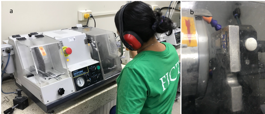
Figura 2.12. Pulidora y cortadora micrométrica Geoforn-Metkon para reducción de espesor en láminas. a) Equipo en operación y b) Detalle del montaje de la muestra.
