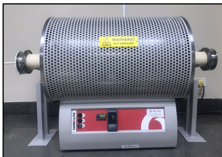
Figura 2.3. Horno Carbolite Gero GHA 12/450 utilizado para tratamientos de recocido y envejecimiento.
