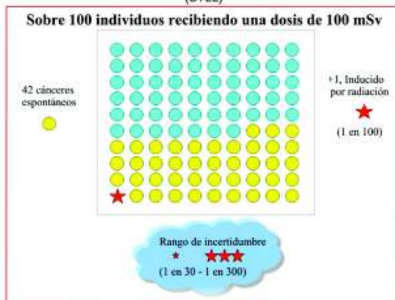
Figura V. Modelo de Riesgo sobre Efectos Biológicos de la Radiación Ionizante del VII Comité (BEIR VII). Estimación del Riesgo de Cáncer. Exposición a dosis única de 100 mSv de radiación de Baja Transferencia Lineal de Energía (BTLE)
