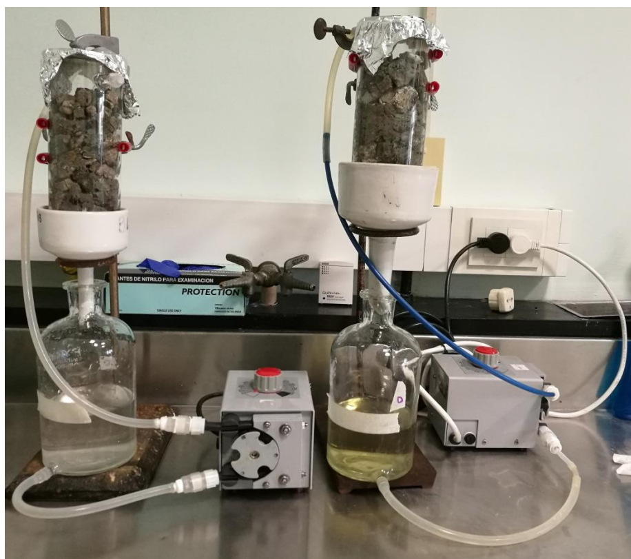
Figura 22. Fotografía de las pilas por goteo de las condiciones C (izquierda) y D (derecha).
