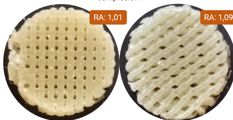
Figura 33. Representación de las muestras con 60 días de inmersión luego de ser ensayadas por compresión. A la izquierda, tipo L y a la derecha, tipo T.
