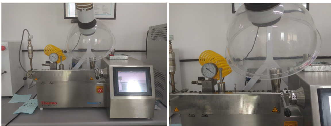
Figura 5. A la izquierda, la mini extrusora Thermo Fisher Scientific Process 11. A la derecha, se observa mejor la tolva y la campana extractora de volátiles de la mini extrusora.
