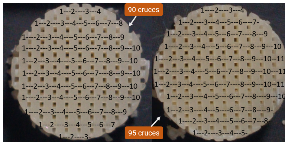
Figura 42. Esquema de cruces para dos andamios tipo L. A la izquierda, teniendo 90 cruces. A la derecha, teniendo 95 cruces.
