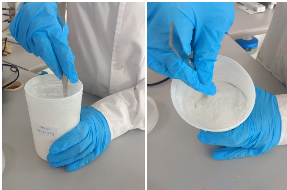
Figura 45. Imagen que muestra la mezcla simple del PHBV - 4% BG.
