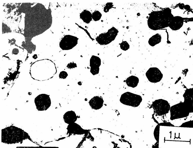
Fig. 9 - Réplica de extracción de un área similar a la de la Fig. 6.
