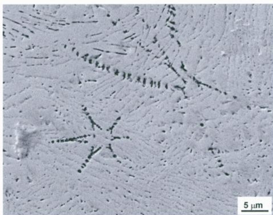
Fig. 3.7.b. Microestructura de la aleación B2 templada. Cristales de \gamma_{\text{Cu-Zn}} en una matriz de \text{Sn}\beta con agujas de Zn .
