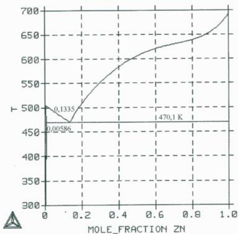
Fig. 6.2. Diagrama calculado en el presente trabajo con parámetro SRCD = 0,0791
