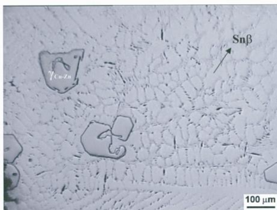
Fig. 3.4. Microestructura de la aleación A14 solidificada a 5°C/min. Cristales primarios de \gamma_{\text{Cu-Zn}} , cristales de \text{Sn}\beta , agujas de Zn.
