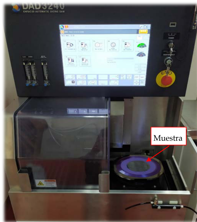
Figura 5.21 – Montaje de la muestra en la sierra de corte DAD 3240.
