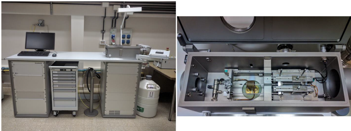
Figura 3.1. Dilatómetro Bähr modelo DIL 805 A, que proveyó los resultados analizados en este trabajo.
