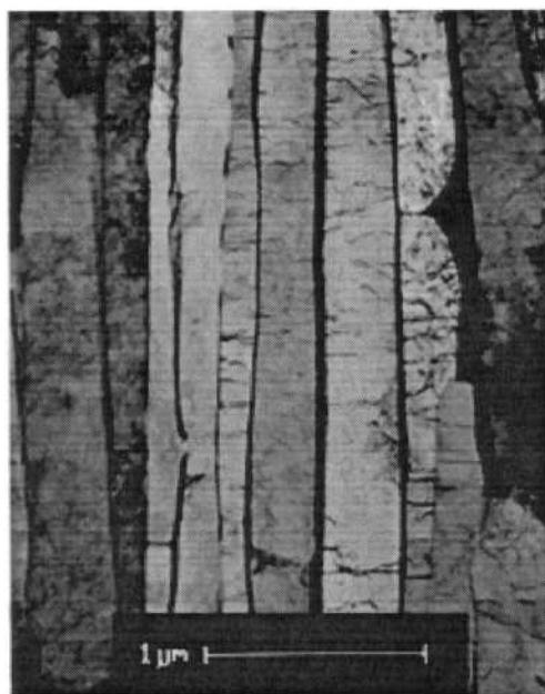
Figura 4.2. Micrografía TEM de la microestructura de un tubo de presión de la sección tangencial normal.
