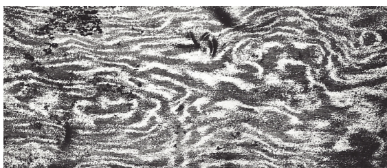
Fig. 5 - Aspecto del damasquinado. Las zonas claras son las que reflejan más la luz porque contienen muchos carburos.
