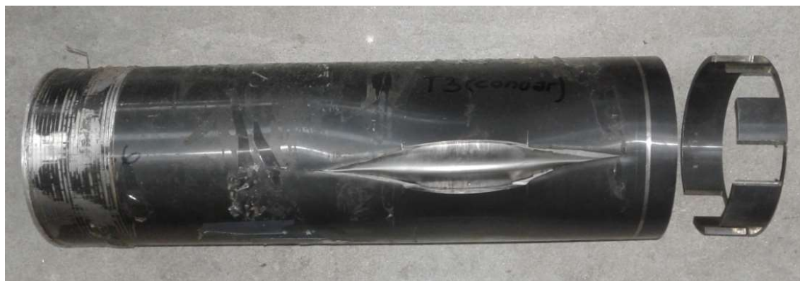
figura 5. A la izquierda del tubo se ve la porción utilizada para extraer las probetas a ensayar.
