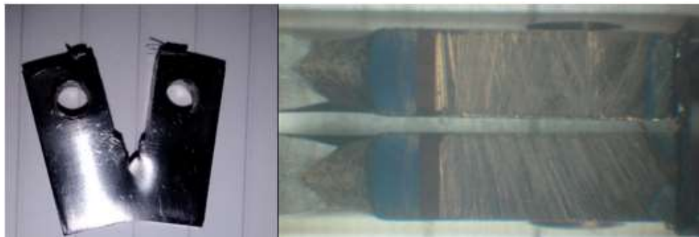
figura 35. A la derecha probeta compacta de acero después del ensayo y a la izquierda después del tinte térmico
