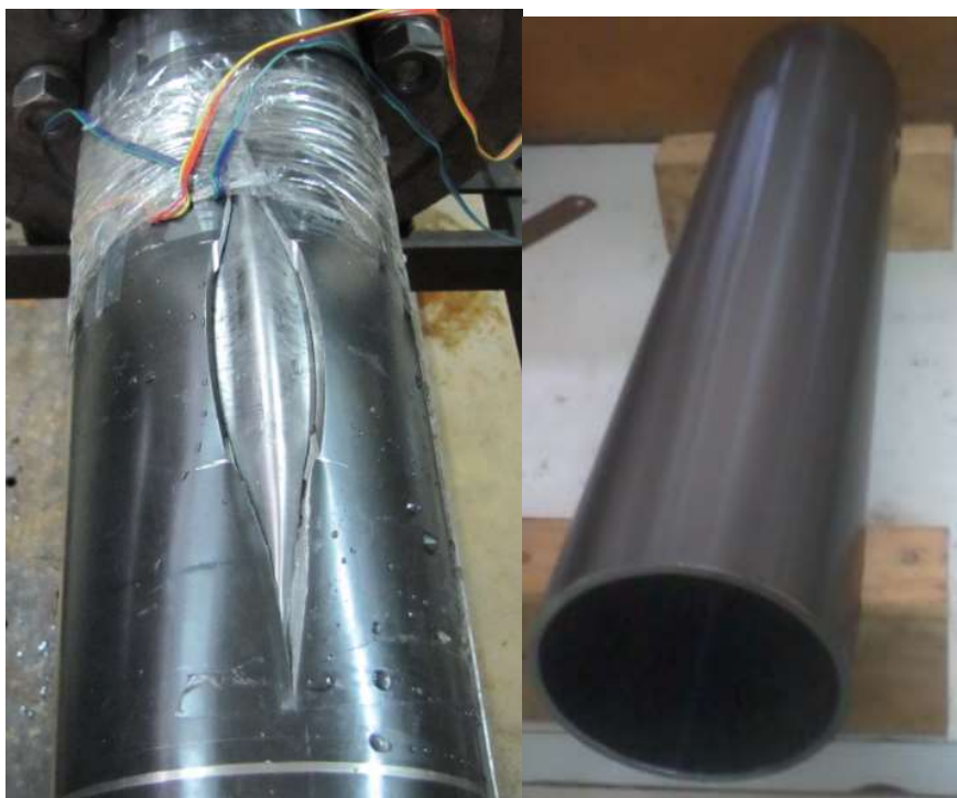
figura 59. Tubo de presión T3 de Zr-2,5%Nb antes y después del ensayo. Puede apreciarse un gran crecimiento de fisura.
