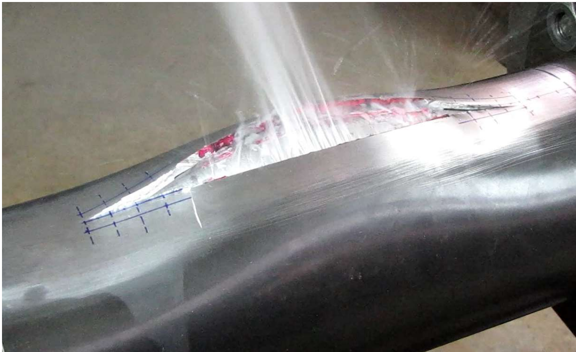
figura 90. Punto de inestabilidad de uno de los tubos de Zr-2.5%Nb.
