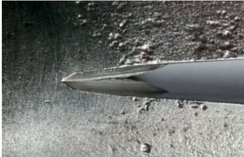
figura 83. Punta de la fisura del tubo de acero.
