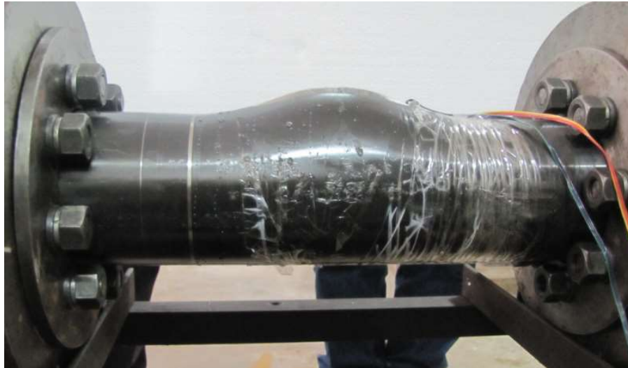
figura63. Deformación plástica en la entalla.
