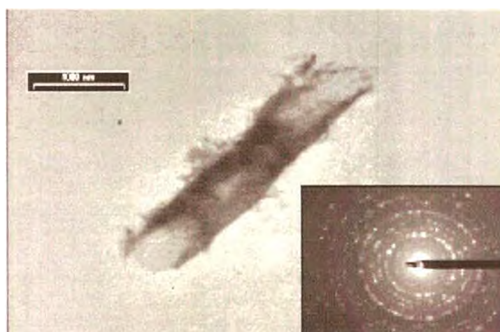
Figura 3.9: Micrografía TEM de un tubo y en el recuadro inferior la imagen de difracción de electrones correspondiente
