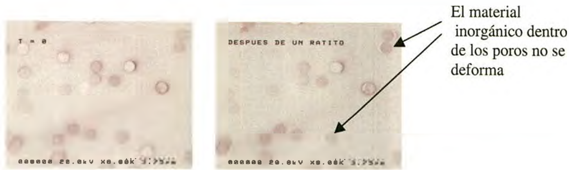
Figura 3.4: Micrografías SEM de la membrana de PC después del tratamiento con microondas
