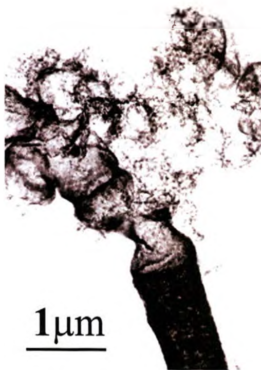
Figura 3.33: Micrografía TEM del borde de un tubo de \Phi_{nominal} = 800nm
